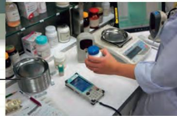
③必要な薬が入った散剤容器を取り、容器に貼付されたバーコードを認証します。この時、薬が一致しなければ調剤できない仕組みになっています。
