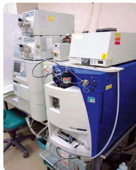
液体クロマトグラフ-タンデム型質量分析装置(LC-MS/MS)
