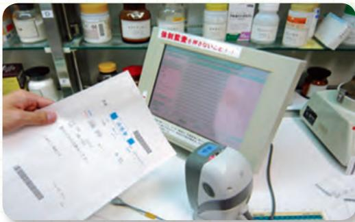
②薬袋に印字されたバーコードをバーコードリーダーで認証し、画面に処方情報を表示させます。
