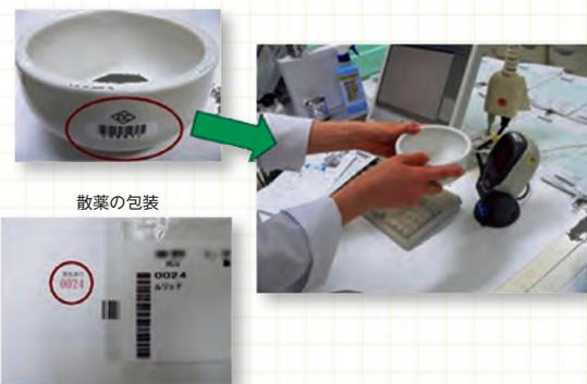
⑤秤量・混合後、秤量皿あるいは乳鉢に貼付されたバーコードを分包機に備え付けたバーコードリーダーで認証します。それによって、登録された患者さんの情報や分包数などのデータが分包機に自動転送され、分包が開始されます。
