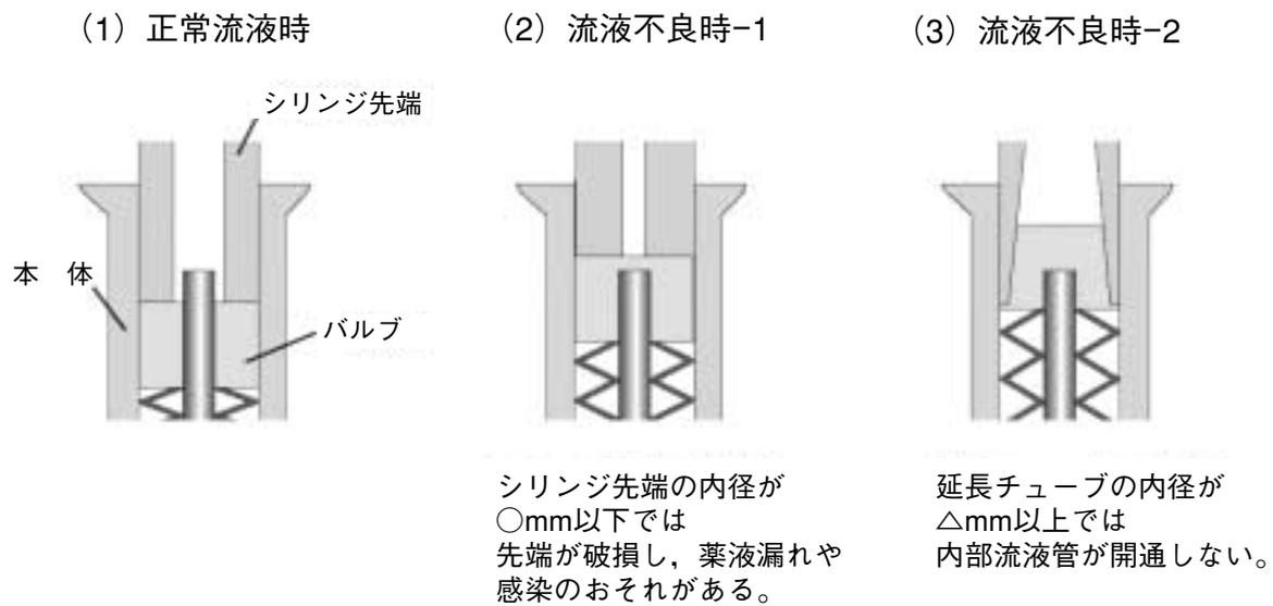
図3 スリット開口型ニードルレス機器
